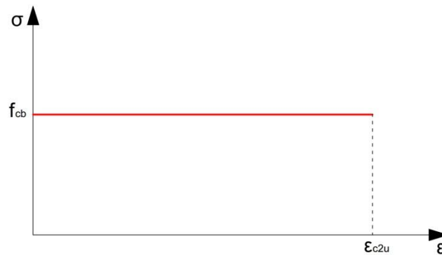
Figura 25 : Distribuição das tensões no concreto comprimido segundo DIN 1045-1 (2001).
